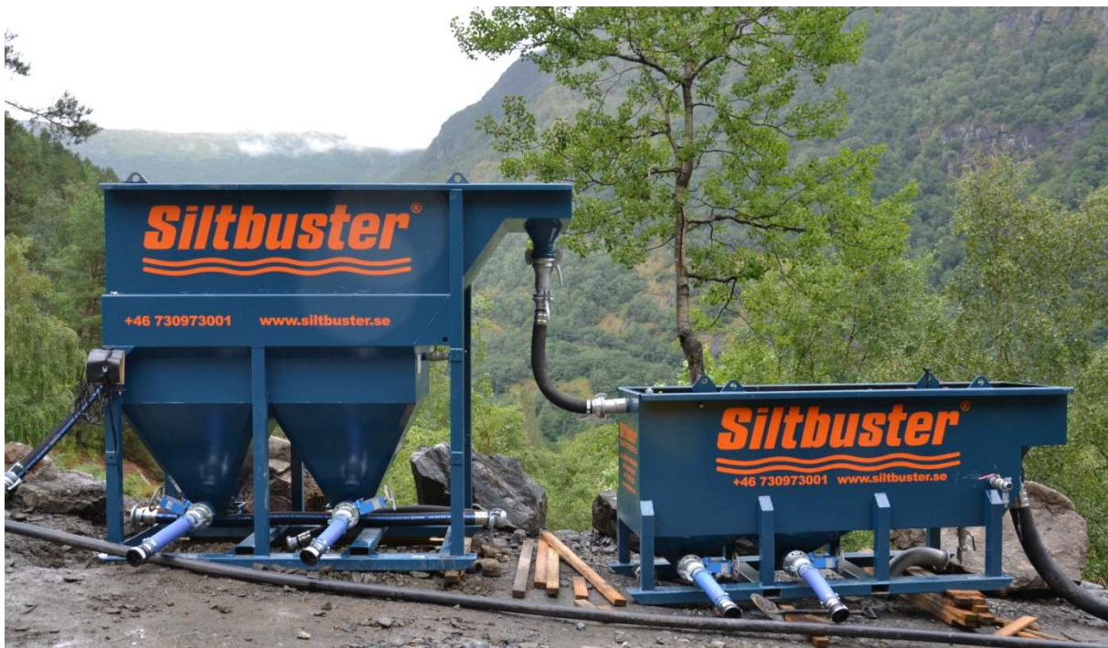
Figur 4.1 , Exempel på lamellsedimenteringscontainers (Foto Johan Magnusson, NCC)
